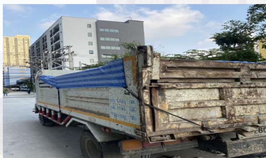
ผ้าใบคลุมวัสดุก่อสร้าง
